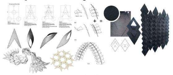
เทคนิคการออกแบบและตัด fabrics ออกมาเป็นหน่วยย่อย (modules) ที่มีรูปร่างซ้ำกันหรือคล้ายกัน และนำมาประกอบกันกลายเป็นโครงสร้างใหม่ A design and construction technique where fabrics are cut into repetitive or similar-shaped modules and then assembled into a new structure.
